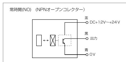
スイッチ取付け、取外し時は必ず電源を切ってから行ってください。
