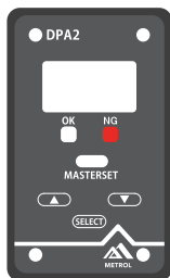
OK判定 (点灯)
