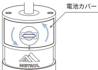
2. 電池を電池向きシールに合わせて電池ケースにセットします。
