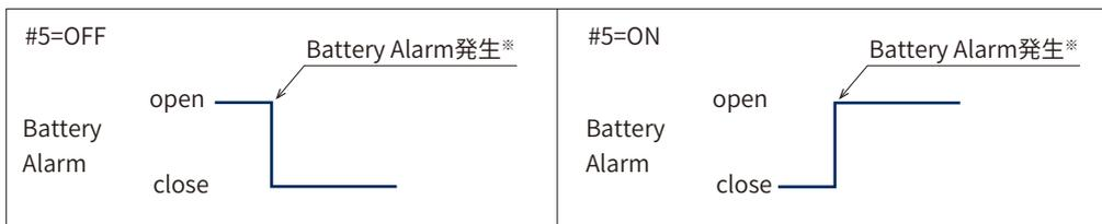
※計測モード時にバッテリーが低下した後、一度スリープモードへ移行し、再び計測モードへ移行した際に Battery Alarm信号を出力します
