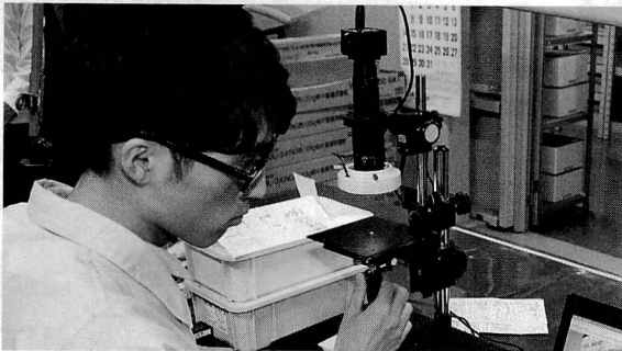
テストルームでは、製品を一個ずつチェック。拡大鏡を使った精密検査で、同社の品質を管理
