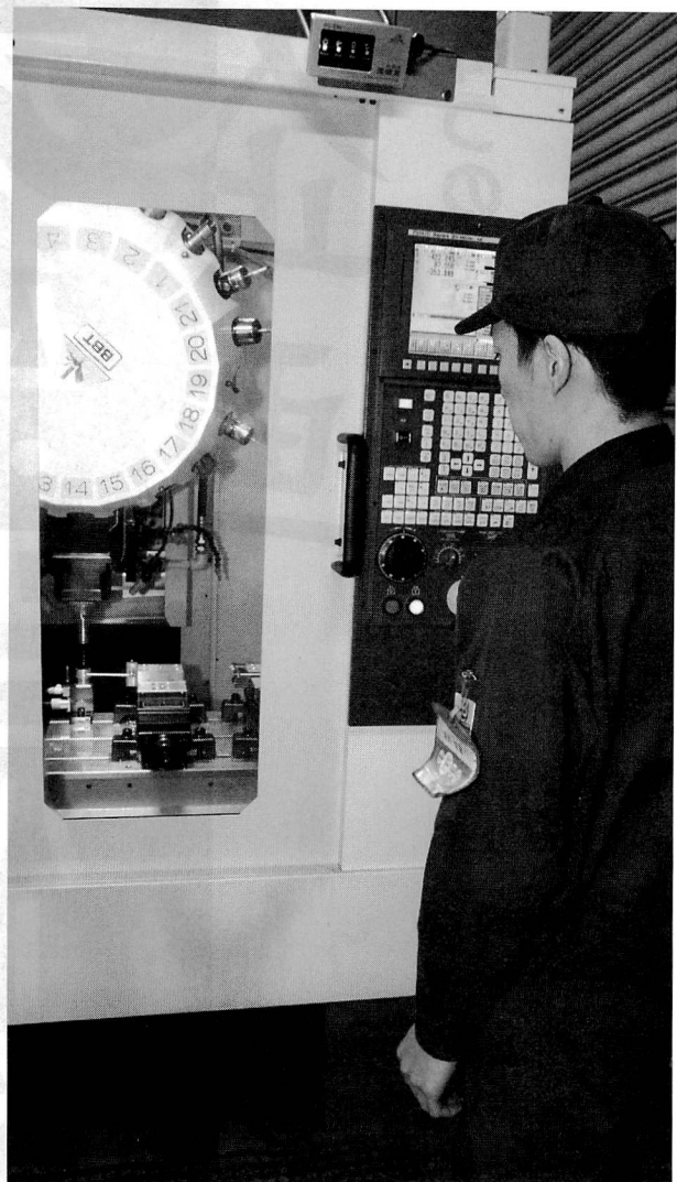
工具の原点確認、起点確認を10000分の1ミリの精度でコントロールするセンサはさまざまなCIVC工作機械に採用されている
