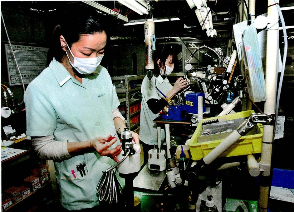
メトロールの製造現場。1人の社員がセル生産をしてセンサー1つひとつを責任持って完成させ、余分な在庫は持たない
