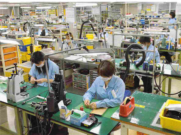
組立工程はライン式ではなく、「1個流し方式」で一人ひとりが違った製品を作り上げている
