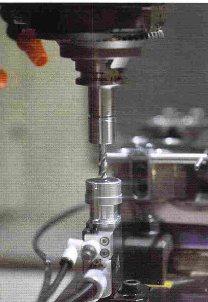
当社の原点とも言える「精密位置決めスイッチ」を元に精密化・自動化した「CNC工作機械用ツールセッタ」
