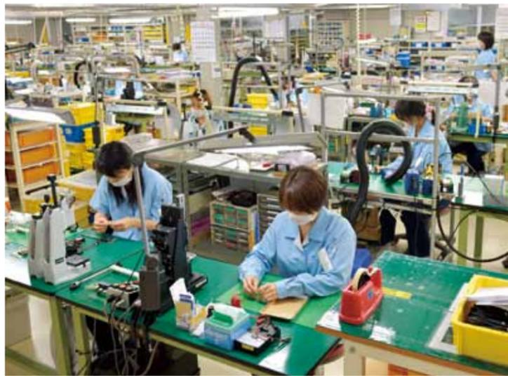
組立工程はライン式ではなく、「1個流し方式」で一入ひとりが出た部品を作り上げている
