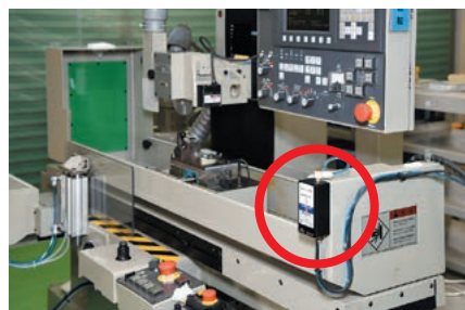
写真3 工作機械に装着された着座センサ (赤丸内)
